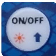
Tecla para ligar e desligar o equipamento. após ligado tecla que acende o backlight e também é uma tecla para incrementar e validar calibração.
