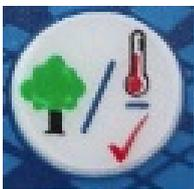
Tecla para alterar a função na tela, peso madeira e CAL (calibração).
