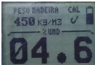
Display para apresentação do teor de umidade, peso da madeira, calibração e mostrador de bateria.
