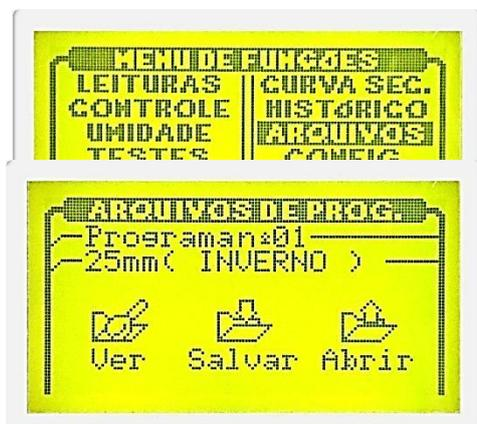
Função destinada ao arquivamento de programas utilizados nos processos de secagem. Permite a visualização e ações dos programas arquivados.
