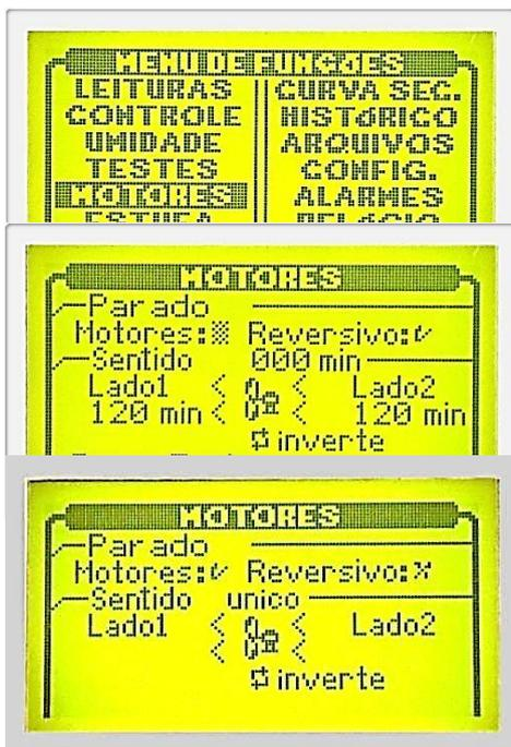
Configuração dos parâmetros que definem o funcionamento dos motores da ventilação da estufa. As estufas possuem ventilação reversiva (alterna o sentido) ou apenas num único sentido, que são característica de sua fabricação. Apenas no sistema reversivo é que programamos a duração do tempo para cada sentido e um intervalo “Pausa” na inversão.
