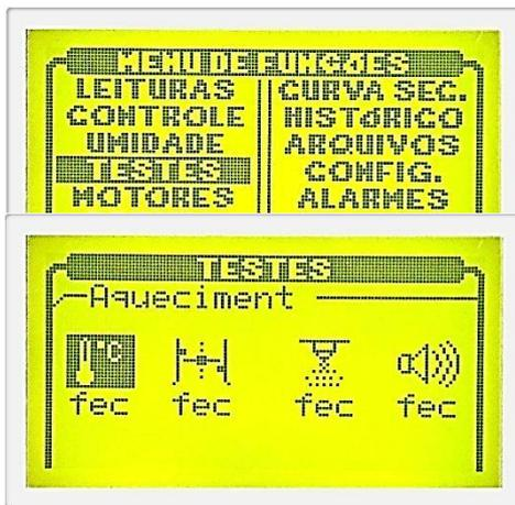
Permite atuar manualmente o acionamento das saídas de aquecimento, renovação de ar (dampers), banho (umidificação) e alarme. Com o auxílio das teclas (◀) e (▶) seleciona-se a saída desejada, as teclas (▲) (▼) abre/fecha.
