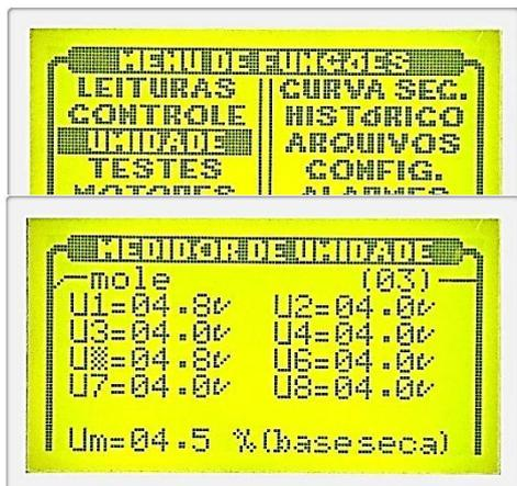
Apresenta a espécie da madeira (escala) utilizada, visualização simultânea dos oito (8) pontos de umidade e sua média (pontos válidos) e os status dos pontos, assim como a opção de manipular manualmente os pontos válidos. Os valores estão em porcentagem (%) de umidade base seca e seguem uma correção conforme a temperatura de controle do processo da secagem.
