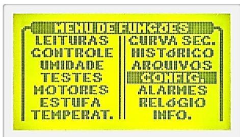
Função destinada a estabelecer limites, critérios e parâmetros no funcionamento do processo da secagem. Alguns são valores ajustados na implantação do sistema, pois são intrínsecos ao modelo de estufa, já outros possuem características de aperfeiçoamento e podem ser no decorrer do processo. De qualquer forma para efetuar qualquer ajuste deve estar sempre embasado num conhecimento técnico.
