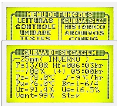
Nesta função o operador define os parâmetros de um programa de secagem, divididos em fases, sendo que a quantidade pode ser limitada de três a vinte fases, em cada fase programa-se o ambiente, forma de condução e duração da secagem.
